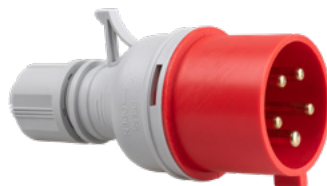
WSP-5-32/22/30 841 Wtyczka przenośna 400V 32A Rodzaj: 32A / 5P Liczba biegunów: 5 Liczba styków: 3P+N+Uziemienie Przyłączalność przewodów: max 10 mm 2 In = 32A
