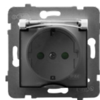
GPH-1USP/m/00/d Gniazdo bryzgoszczelne z uziemieniem schuko, IP-44, z przesłonami torów prądowych
