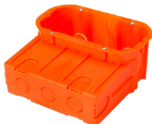
PP-F2x60GŁ-P-K Puszka instalacyjna, końcowa podwójna z wkrętami 2xØ60, głębokość puszki: 60 mm głębokość kieszeni: 50 mm
