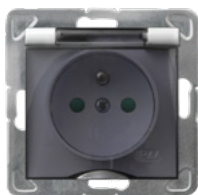
GPH-1YZP/m/00/d Gniazdo bryzgoszczelne z uziemieniem, IP-44, z przesłonami torów prądowych
