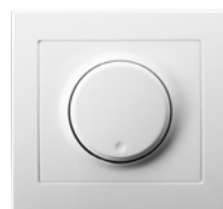
ŁP-8WL2/00 1749 Ściemniacz uniwersalny, zakres obciążenia: GLS 10-250W, CFL 5-75W, LED 0-100W, funkcja wyłącznika czasowego i „time to bed”
