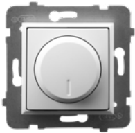
ŁP-8U/m/00 2113 Ściemniacz przyciskowo-obrotowy, przystosowany do obciążenia żarowego i halogenowego, zakres obciążenia 40-400W
