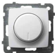
ŁP-8SL2/m/00 1574 Ściemniacz uniwersalny, zakres obciążenia: GLS 10-250W, CFL 5-75W, LED 0-100W, funkcja wyłącznika czasowego i „time to bed”
