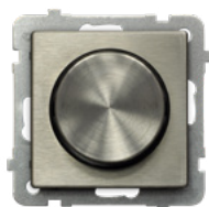
ŁP-8RML2/m/44 Ściemniacz uniwersalny, zakres obciążenia: GLS 10-250W, CFL 5-75W, LED 0-100W, funkcja wyłącznika czasowego i „time to bed”
