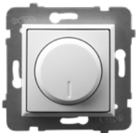
ŁP-8UL2/m/00 2114 Ściemniacz uniwersalny, zakres obciążenia: GLS 10-250W, CFL 5-75W, LED 0-100W, funkcja wyłącznika czasowego i „time to bed”
