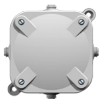
ONH-4A5 854 Odgałęźnik instalacyjny ścienny - 4x4mm 2 , 4-wylotowy, 5-torowy, dławnice bezgwintowe, IP-44
