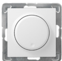
ŁP-8YL2/m/00 2005 Ściemniacz uniwersalny, zakres obciążenia: GLS 10-250W, CFL 5-75W, LED 0-100W, funkcja wyłącznika czasowego i „time to bed”
