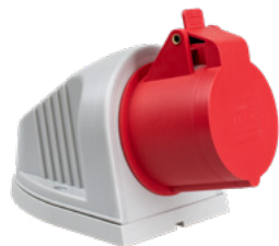
GSS-5-16/22/30 Gniazdo stałe 400V 16A Rodzaj: 16A / 5P Liczba biegunów: 5 Liczba styków: 3P+N+Uziemienie In = 16A
