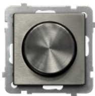
ŁP-8RML2/m/37 Ściemniacz uniwersalny, zakres obciążenia: GLS 10-250W, CFL 5-75W, LED 0-100W, funkcja wyłącznika czasowego i „time to bed”
