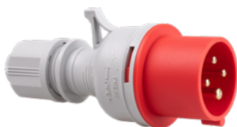
WSP-4-16/22/30 837 Wtyczka przenośna 400V 16A Rodzaj: 16A / 4P Liczba biegunów: 4 Liczba styków: 3P+Uziemienie Przyłączalność przewodów: max 6 mm 2 In = 16A
