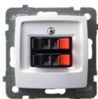
GG-2S/m/00 1545 Gniazdo głośnikowe, podwójne przyłączalność przewodów 0,75 mm 2
