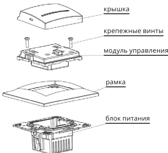
Рис. 1 / Пример монтажа карточного выключателя.
